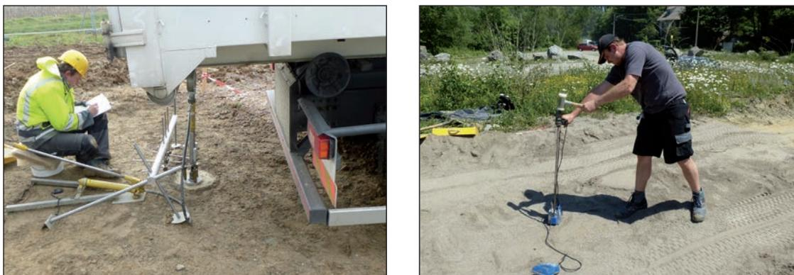
Figure 3.3 – Essais géotechniques réalisés avant et en cours de projet (essai à la plaque et essai PANDA)
