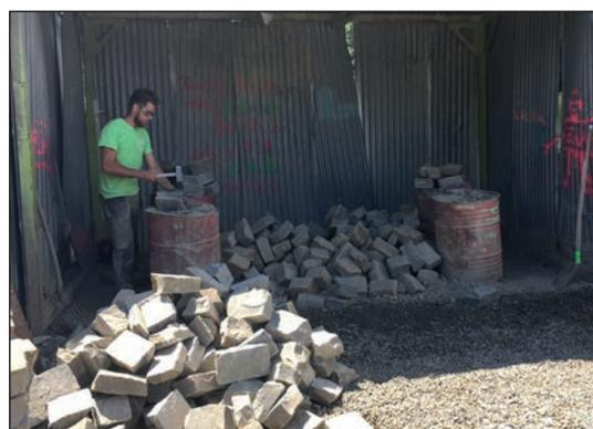
Figure 1.9 – Taille et épincage des blocs de grès
