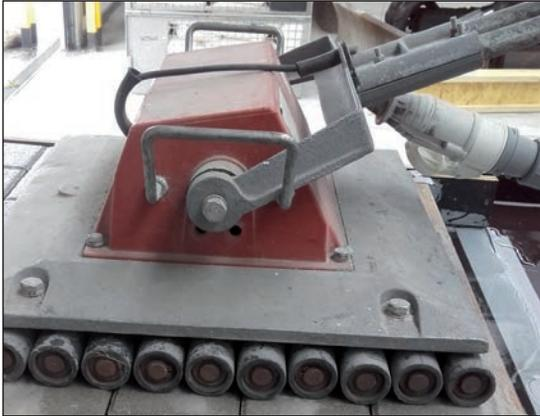
Figure 4.21 – Appareil ultrason sur roulettes
