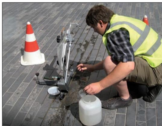
Figure 2.6 – Pendule SRT pour la mesure de la glissance
