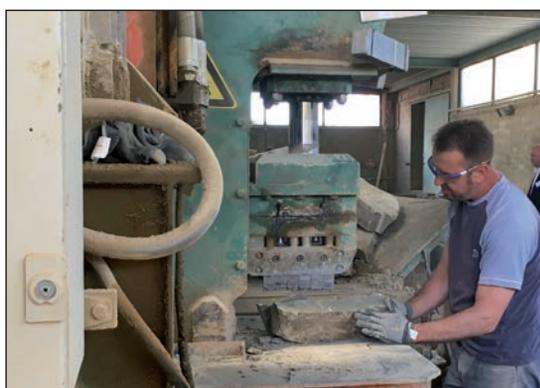
Figure 1.8 – Clivage en blocs aux dimensions du produit fini
