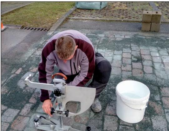
Figure 4.19 – Mesure de l'adhérence au pendule SRT
