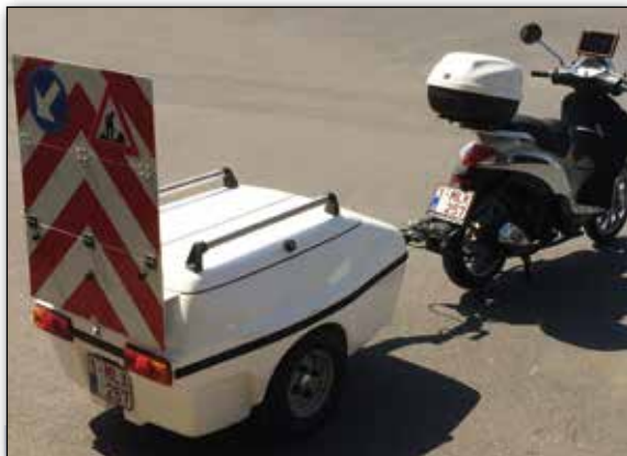
Figuur 1 – Fietspadprofilometer van het OCW voor de controle van de langsvlakheid van fietspaden
