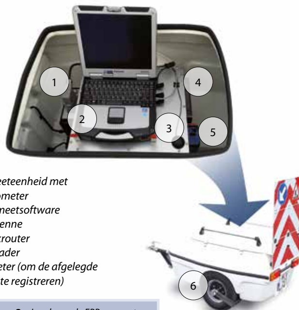
Figuur 2 – Ingebouwde FPP-apparatuur
