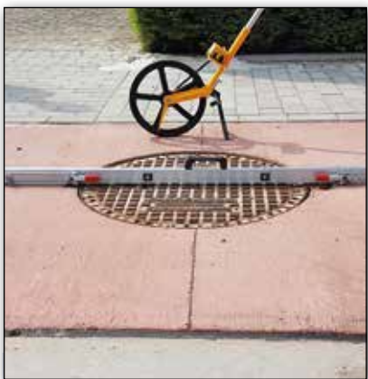
Figuur 7 – Aanwezigheid van putdeksels in een fietspad geeft vaak aanleiding tot een piek in de vlakheidsmeting
