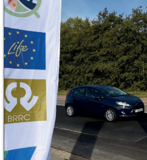
Metingen tijdens een testrit over het poro-elastische proefvak toonden een geluidsreductie van 7 tot 9 dB aan
