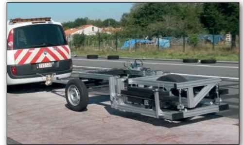
Figuur 2 – ARW2 op een testbaan in Nantes tijdens ROSANNE-metingen
