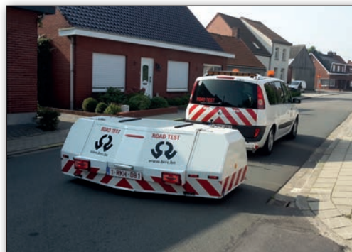
Figuur 3 – CPX-aanhangwagen van het OCW in de Zandvlietse Dorpstraat te Zandvliet
