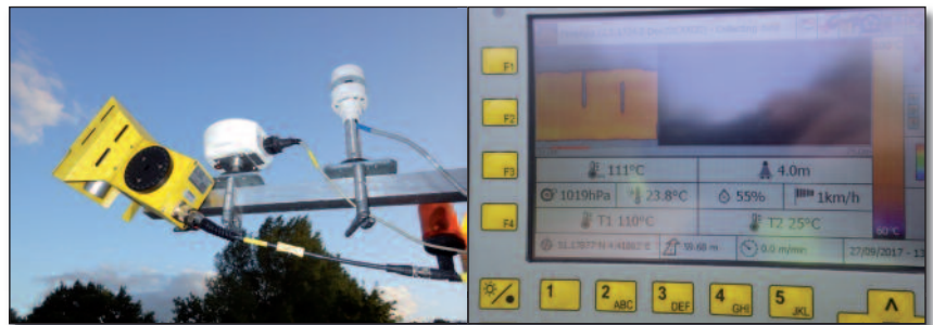
Figuur 5 – IR-linescanner met gps-module en weerstation (links) en verwerkingseenheid (rechts)
