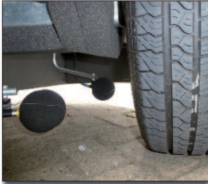
Figuur 2 – Binnenkant van de CPX-aanhangwagen van het OCV, met P1-band
