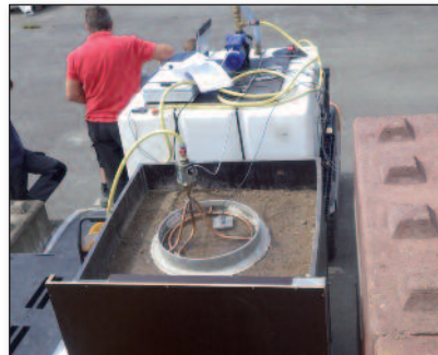
Figuur 3 – Dubbele-ringproef voor doorlatendheidsmetingen
