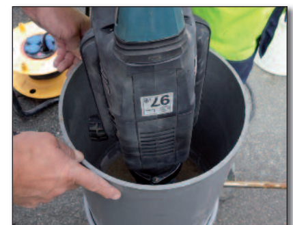
Figuur 4 – Kolomdoorlatendheidsproef: principetekening en verdichting van het materiaal
