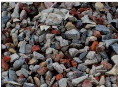
Figuur 2 – Mengpuinsteenslag kan tot 50 % metselwerkpuin bevatten
