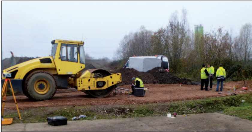
Figuur 1 – Op het eerste APERROUT-proefvak werd gedurende twee winterperioden het langetermijngedrag van mengpuinsteenslag onder invloed van natuurlijke vorst-dooicyclusen onderzocht
