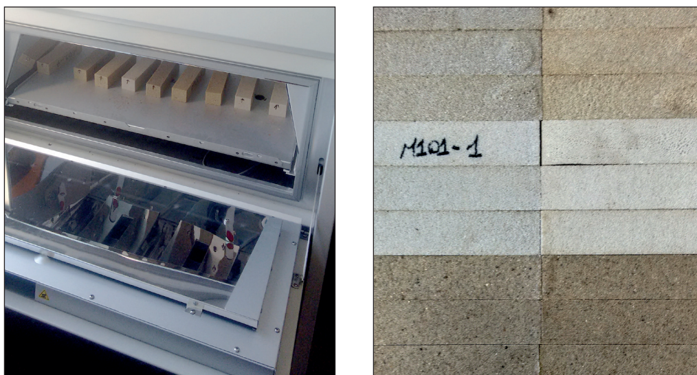
Figure 16 – Vieillessement UV de mortiers de jointoiment liés à la résine dans une chambre climatique (à gauche) et comparaison entre des éprouvettes exposées aux UV ou non (à droite)
