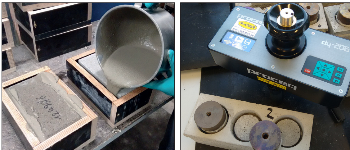
Figure 20 – Essais d'adhérence directe entre les pavés et le mortier de jointoiment selon la NBN EN 1542
