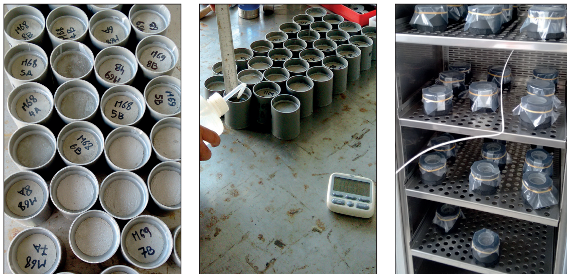
Figure 10 – Essai de résistance au gel-dégel en présence de sels de déverglçage pour les mortiers de jointoiment liés au ciment
