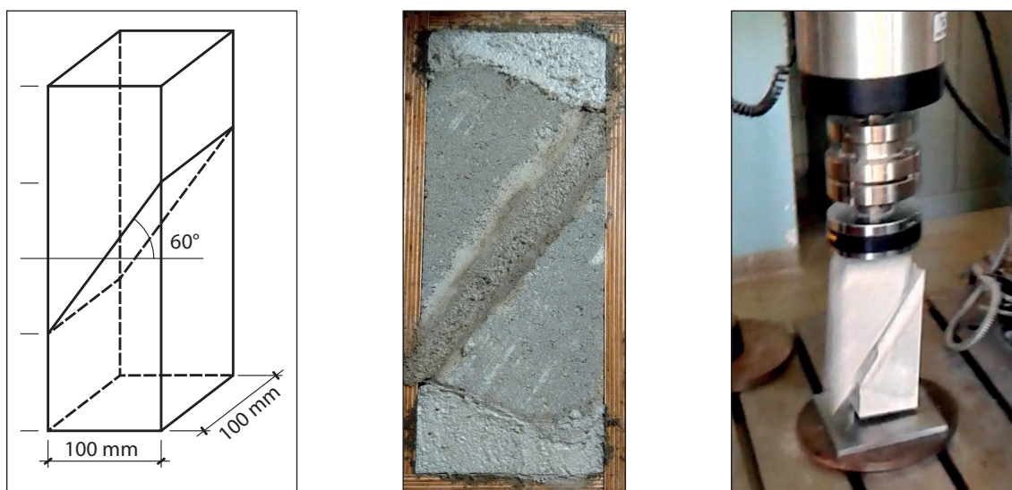
Figure 22 – Essais de résistance au cisaillement entre le pavé et le mortier de jointoiment, basée sur le Slant shear test selon la NBN EN 12615
