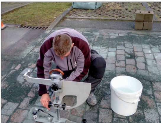
Figuur 4.19 – Stroefheidsmeting met een SRT-apparaat
