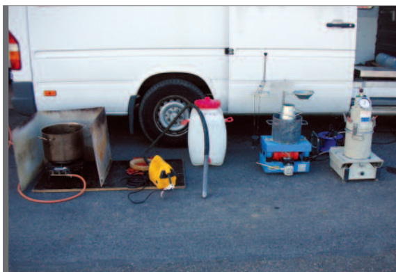
Figuur 5.1 Proeven op verse beton op de werf
