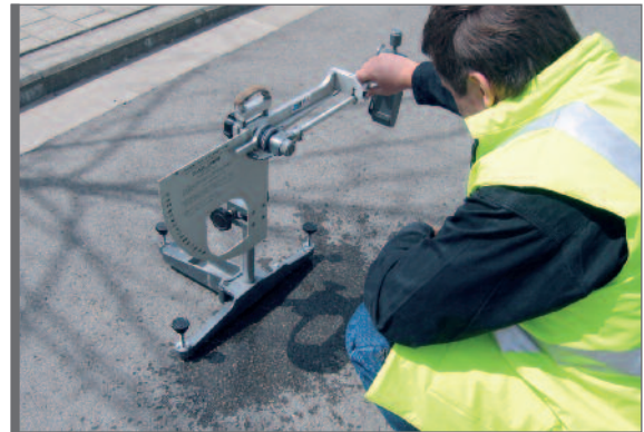
Figuur 5.4 Opmeten van stroefheid met SRT-slinger
