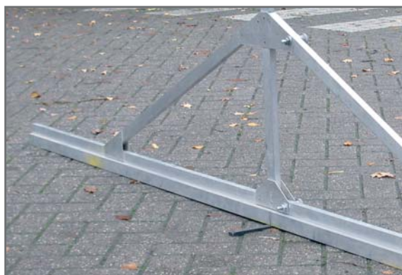
Figuur 4.5 Meten van oneffenheden met behulp van regel van 3 m
